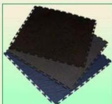
**Popis:** barevná protiskluzná podlahovina z recyklovaného PVC, tloušťky 5mm. Dezén povrchu je charakteru stromové kůry nebo s vystouplými kapkami. K dispozici 2 základní barvy, nájezdová rampa, rohy. Čtverce se zazubenými okraji mají rozměr 42 x 42 cm. Spojují se mechanicky, není nutné je k podkladu lepit.
