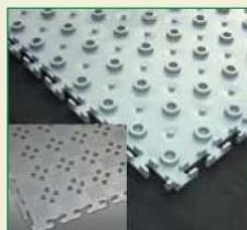
**Popis:** protiskluzná podlahovina z PVC. Čtverce se zazubenými okraji rozměru 50 x 50 cm. Spojují se mechanicky, k podkladu se nelepí. Povrch je buď s otevřenou strukturou - děrovaný (Open, tl. 14mm) nebo celistvý (Comfort, tl. 17mm) s terčíky na povrchu. Rub opatřen distančními prvky, zvyšujícími ergonomii podlahy. Barva šedá, černá.
