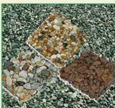
Popis: dvousložková podlahovina na bázi transparentního pojiva a kaménků různých frakcí (např. 4-8, 8-16 a více mm). Je zpracována ručním náradím (ruční pokládkou). Je tvarově a barevně značně variabilní, bezespará, ale propustná pro vodu, s protiskluzovými vlastnostmi. Na balkónech a terasách je podkladem izolační vrstva, na volné ploše potěr nebo beton. Je mechanicky a chemicky odolná.
