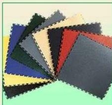
**Popis:** barevná protiskluzná podlahovina z PVC, tloušťky 7mm. Čtverce se zazubenými okraji rozměru 50 x 50 cm. Spojují se mechanicky, není nutné je k podkladu lepit. K dispozici 8 základních barev, nájezdová rampa, rohy. Tři typy povrchů -hladký, strukturovaný, terčíky. Na objednávku jsou čtverce s výstražnými nebo informačními piktogramy.
