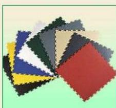
**Popis:** barevná protiskluzná podlahovina z PVC, tloušťky 5mm. Dezén povrchu pomerančová kůra, k dispozici 7 základních barev, nájezdová rampa, rohy. Čtverce se zazubenými okraji mají rozměr 50 x 50 cm. Spojují se mechanicky, není nutné je k podkladu lepit.
